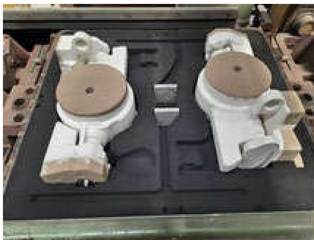
Figura 3: esempio di forma per getto pesante con anime di dimensioni grandi e elevata superficie di contatto
