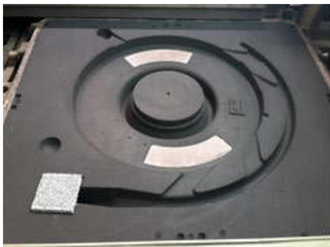
Figura4: esempio di forma per getto leggero senza anima
